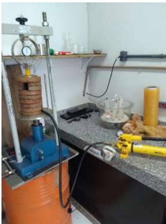
Figura 14 - Montagem para a calibração da célula de carga
