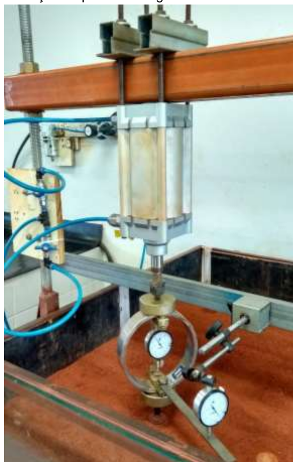
Figura 16 – Esquema de montagem e instrumentação da prova de carga convencional
