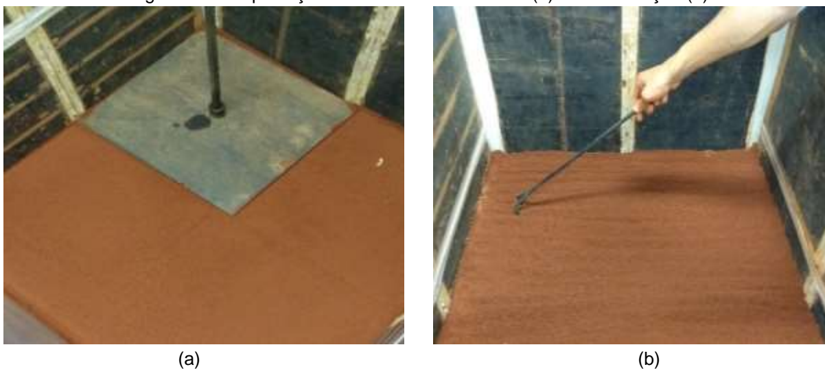
Figura 9 - Compactação de uma camada de solo (a) e escarificação (b)
