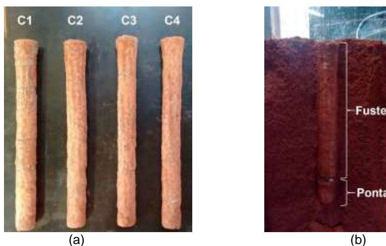
Figura 18 – Estacas do Modelo C exumadas (a) e Detalhe da exumação de estaca do Modelo B (b)
